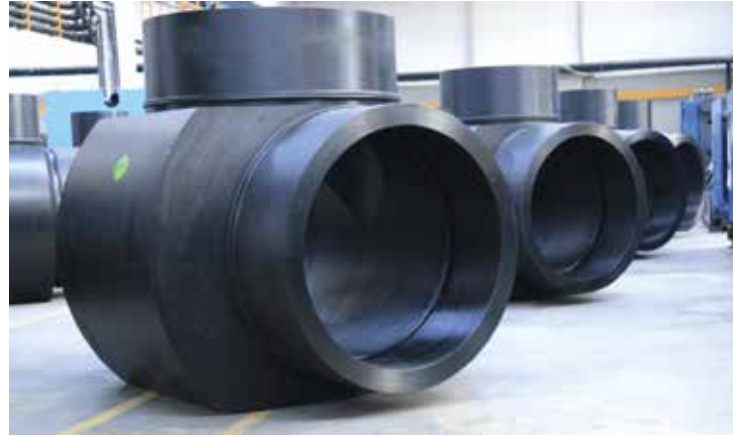
Hollowbar/Solid Bar'dan üretilmiş d1800mm TE Parçaları
